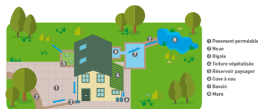
Exemple de différentes techniques alternatives possibles pour gérer les eaux pluviales d'une maison Source : SYMASOL
